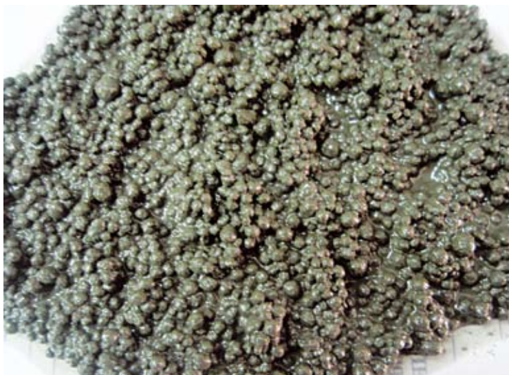
Рис. 2. Вид глины в инвертно-эмульсионном растворе после термостатирования в динамических условиях при 100 °С в роллерной печи
