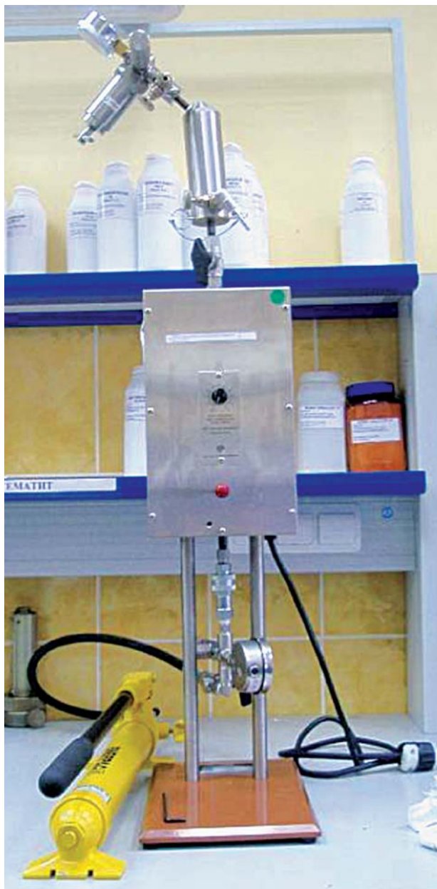
Рис. 2. Тестер проницаемости тампонирующего раствора производства OFITE (PPT – Permeability Plugging Tester)
