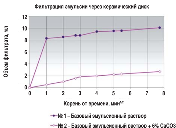
Рис. 4. Результаты фильтрации эмульсии через керамический диск и определения восстановления проницаемости
