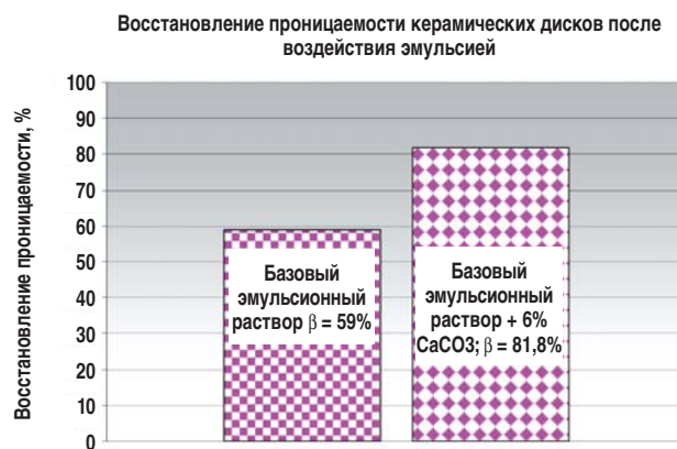
Рис. 4. Результаты фильтрации эмульсии через керамический диск и определения восстановления проницаемости
