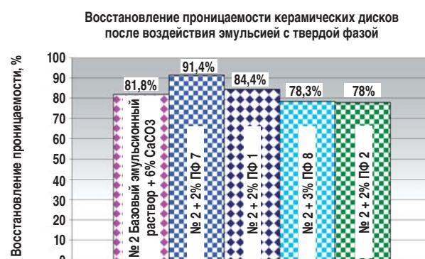
Рис. 4. Результаты фильтрации эмульсии через керамический диск и определения восстановления проницаемости
