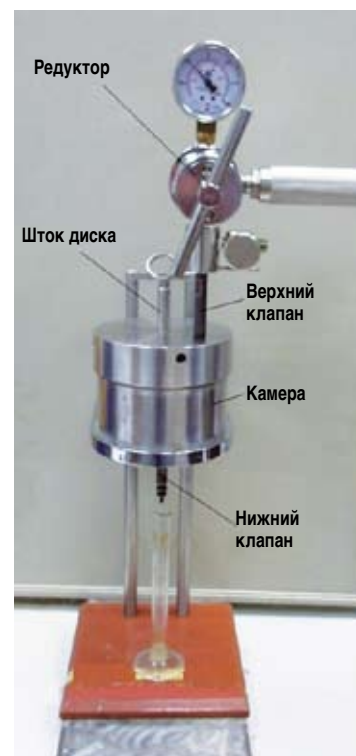
Рис. 3. Формирование фильтрационной корки
