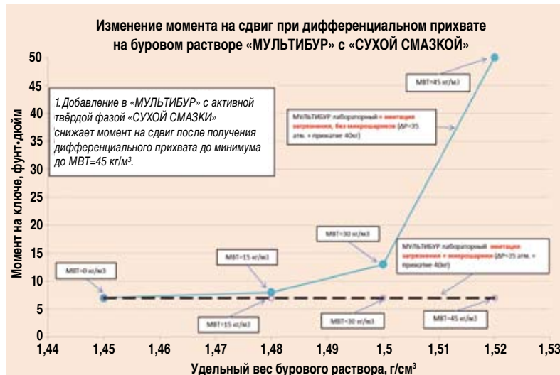
Рис. 9. Изменение момента на сдвиг с буровым раствором «МУЛЬТИБУР» с «Сухой смазкой»
