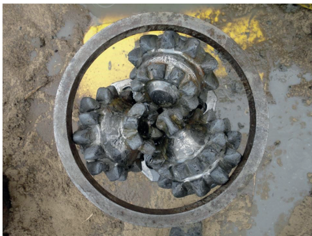
Рис. 4. Долото БИТ 295,3 Z2RSJ U700 после первого рейса
