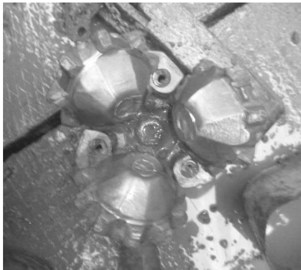
Рис. 3. Износ стального вооружения группы 2
