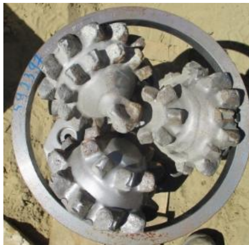
Рис. 2. Износ стального вооружения группы 1
